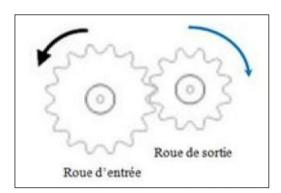
Un engrenage est un mécanisme constitué d'au moins deux roues dentées mobiles en rotation autour de deux axes. Les dents viennent successivement en contact les unes avec les autres, on dit qu'elles « s'engrènent ». Ces roues peuvent avoir différents diamètres et un nombre de dents différent. On appelle « pignon » la roue dentée qui a le plus petit nombre de dents. Le système peut être amorcé par n'importe quelle roue. Le mouvement de transmission est réversible.
