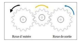
Lorsque le nombre de roues dentées extérieurement est impair, le sens de rotation de la roue d'entrée et le sens de rotation de la roue de sortie sont identiques.
