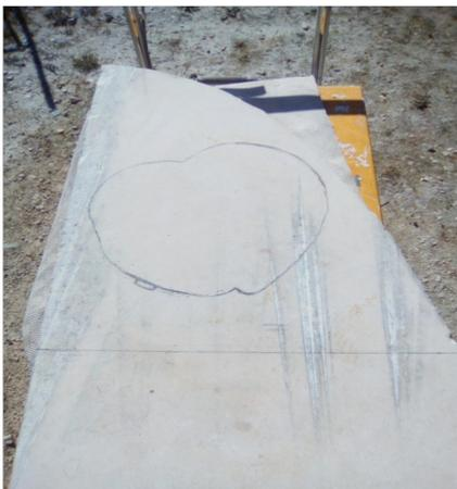
Pour le dessin j'ai utilisé mon modèle en plâtre que j'ai posé sur la pierre afin d'en dessiner le contour, comme si c'était un profil. Pour les parties surhaussées du plâtres (haut du masque) j'ai utilisé une équerre que j'ai posée sur la pierre en la
